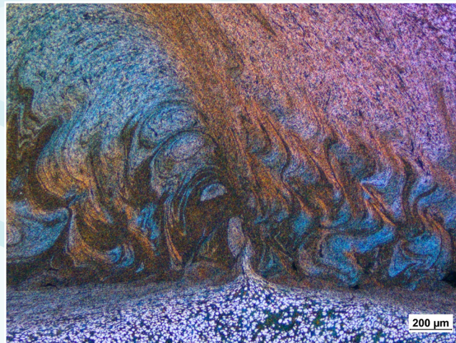
搅拌摩擦焊铝合金, 根据Barker腐蚀, 偏正光+Lambda补偿片, 50倍
