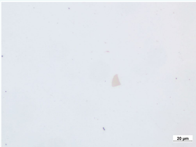
工具钢 X40CrMoV51+QT, 410-470 HV, 横截面, 明场像, 500倍
