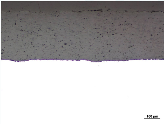
Al 2 O 3 钢基底上的铝涂层，明场像，100倍
